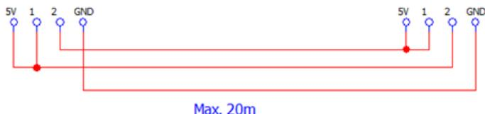
Die maximale Leitungslänge beträgt 20 Meter.
